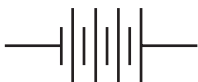
Figura 8. O símbolo de uma bateria se assemelha a uma associação em série de geradores.
